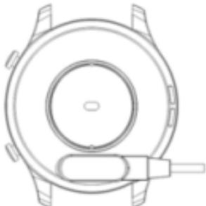
Használja a mellékelt USB-kábelt, amely két tűvel ellátott klipszben végződik. Óvatosan csatlakoztassa a klipszet az órához úgy, hogy a csapok megérítsék az óra alján lévő töltőérintkezőket. Használja a számítógép USB-csatlakozóját vagy egy szabványos DCSV okostelefon-töltőt áramforrásként.
