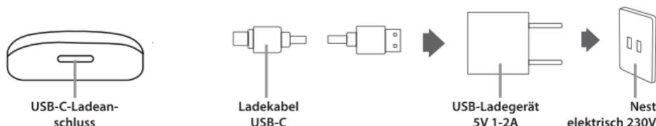
Das Gerät sollte etwa 2 Stunden lang aufgeladen werden. Der LED-Bildschirm zeigt den Ladezustand an, bis der Buchstabe F angezeigt wird, was anzeigt, dass der Ladevorgang abgeschlossen ist.
