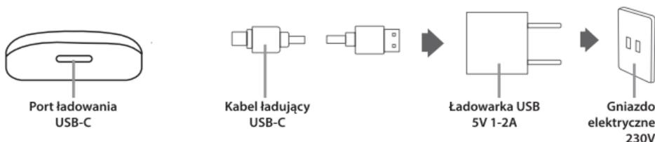
Urządzenie należy ładować ok. 2 godziny. Na ekranie LED będzie pokazywany poziom naładowania do momentu wyświetlenia litery F, co informuje o zakończeniu ładowania.
