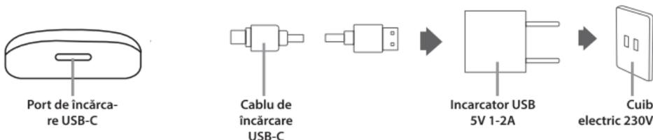
Dispozitivul trebuie încărcat timp de aproximativ 2 ore. Ecranul LED va afișa nivelul de încărcare până când este afișată litera F, ceea ce indică faptul că încărcarea este completă.
